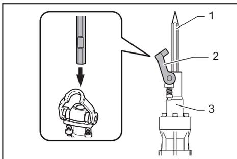
► 1. Bit 2. Tool retainer 3. Tool holder
