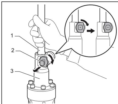
► 1. Bit 2. Tool retainer 3. Tool holder
