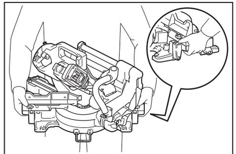
**警告：**抬升刀架的止動銷僅供搬運與存放用途，並非用於任何切割操作。將止動銷用於切割操作可能會造成圓鋸機鋸片意外移動，而導致反彈和嚴重的人員傷害。
