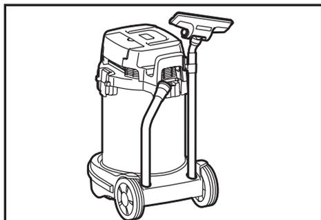
集尘管支撑件可用来存放直管、弯管和类似附件（只需将附件插入）。
